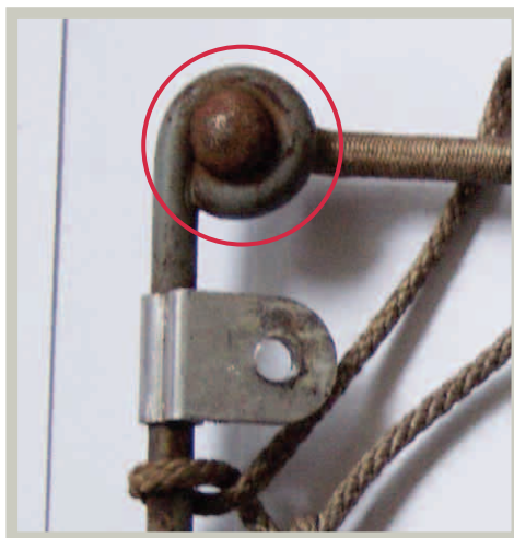
Das Gummi wurde früher mit aufgesetzten Metallknöpfen (hier stark verrostet) in der Rahmenöse gehalten. Es geht auch ein Knoten. Diese Detailansicht ist von der Rückseite des Netzes!
